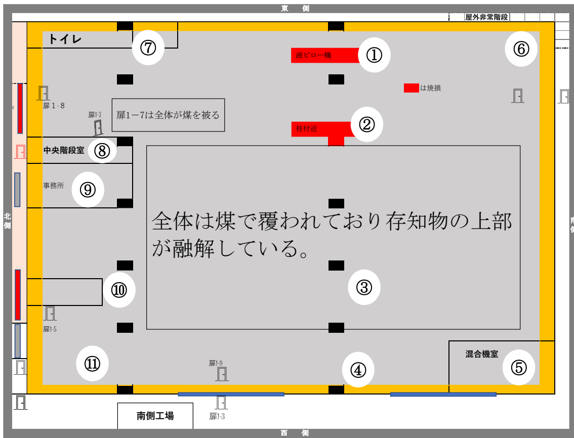
図. 3-15 1階南側工場内部の焼損状況
