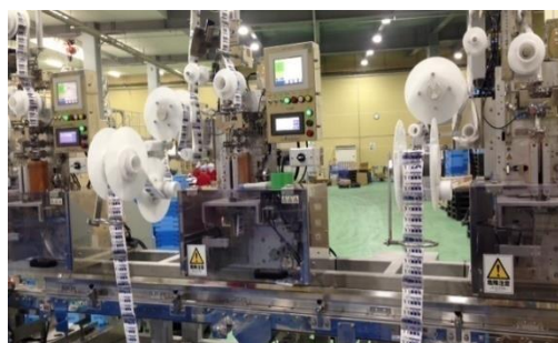
図2-20 粉ピロー機に接続していた搬送機
