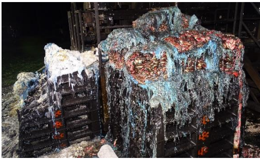
図 3-16 上記①付近 上部が融解した原材料
